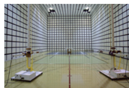
EMC試験の様子(10m法電波暗室)
