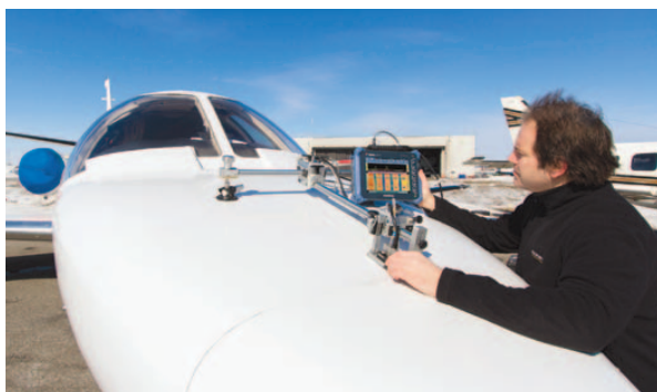
超音波フェーズドアレイ探傷器による機体のCFRP素材内部検査
