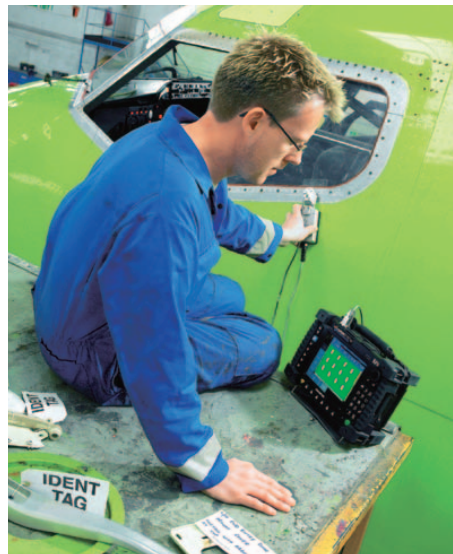
渦流アレイ探傷器による機体表面近傍の検査
