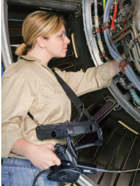
工業用内視鏡によるエンジン検査
